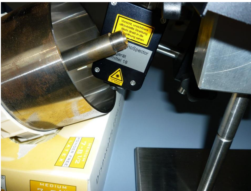
图 2: 传感器位置 - 被部分安装的样品
